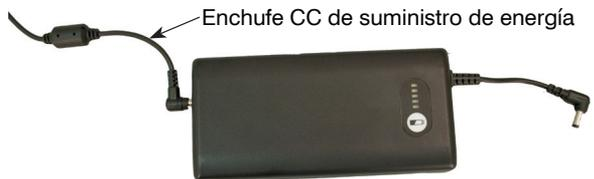
4. Durante la carga, uno de los LED verdes del indicador del nivel de batería parpadeará. Cuando todos los LED permanezcan fijos (sin parpadeo), la batería estará cargada por completo. **NOTA:** Cuando se carga una batería agotada, es posible que transcurran unos minutos antes de que el LED verde comience a parpadear.
